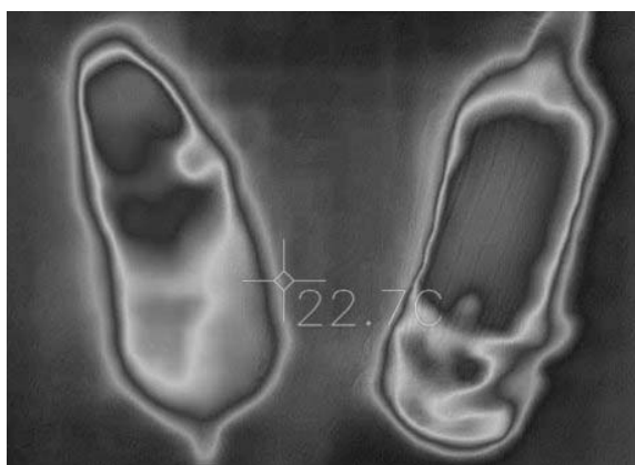
写真-4 ネズミ(左)に似せた疑似餌用 USB 熱源(右)
