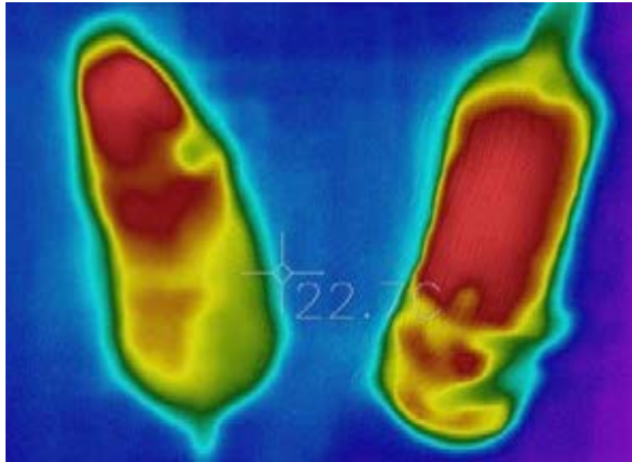
写真-3 ネズミ（左）に似せた疑似餌用 USB 熱源（右）
