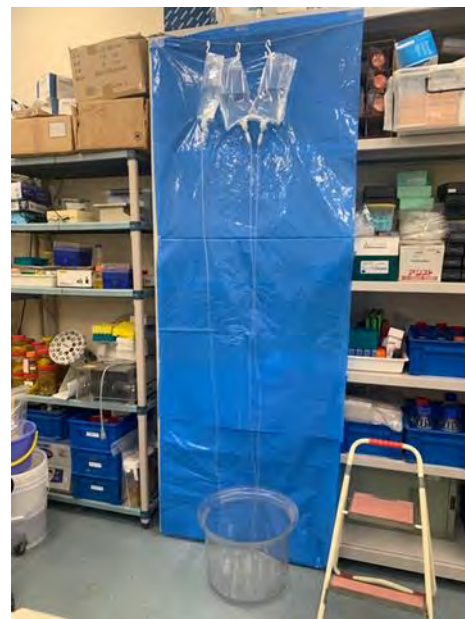
写真-5 重力式濾過システム
