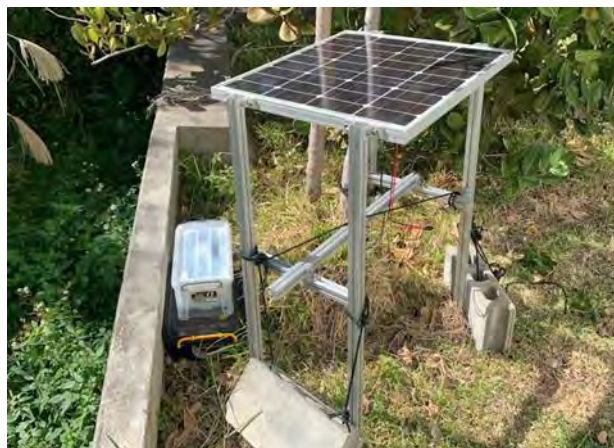
写真-1 ソーラー発電システムを組み込んだ新規トラップ（試作品）
