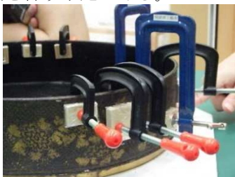
写真-4 塗膜押さえの様子
