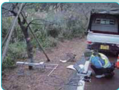
ガンマー線樹木腐朽診断機による調査状況
